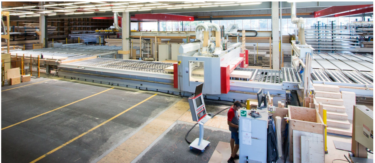
Bild: Die bestehende Grossflächen-CNC-Anlage der Balteschwiler AG, welche nun durch die neuen CNC-Bearbeitungszentren ergänzt wird.
