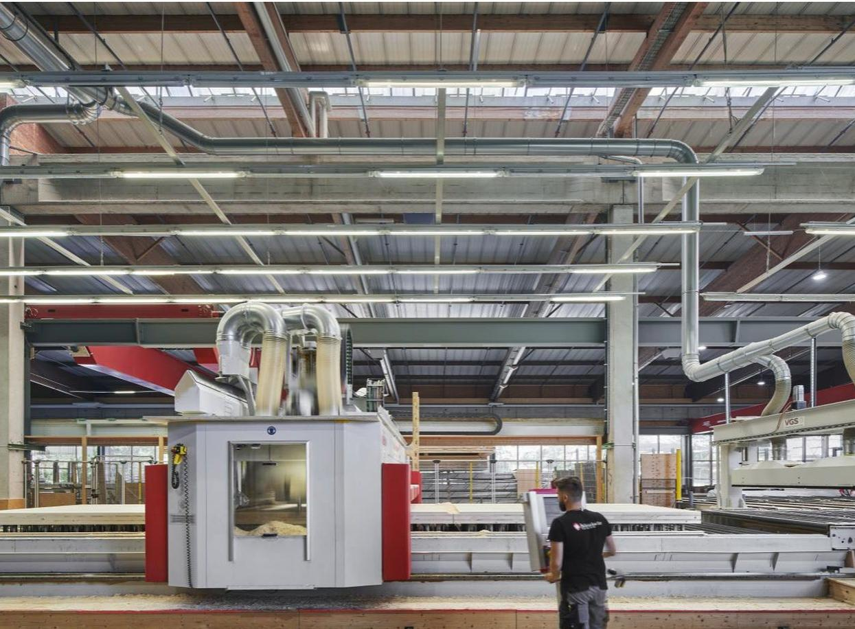
Optimiert auf Zuschnitt von LVL & Holzwerkstoffplatten bis 100mm, inkl. Stirnbearbeitung
