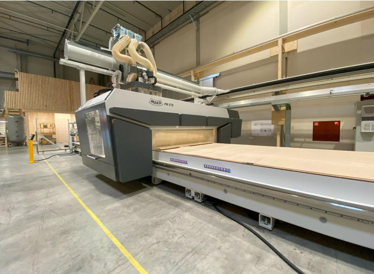
Optimiert auf den Nesting-Zuschnitt von Holzwerkstoffplatten bis 80mm (3-Schichtplatten, OSB, LVL, dünne CLT etc.)
