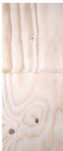
Photo 3 : face avant, ponçage optique, colle incolore dans le joint d'assemblage
