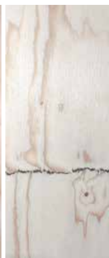
Photo 4 : face arrière, ponçage optique, colle brune foncée dans le joint d'assemblage
