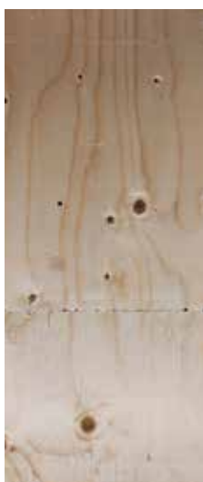
Photo 2 : face arrière, non poncée, colle brune foncée dans le joint d'assemblage
